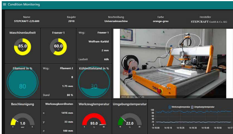
Abbildung 57: Modulares Monitoring-Dashboard am Stepcraft-2/D.600
